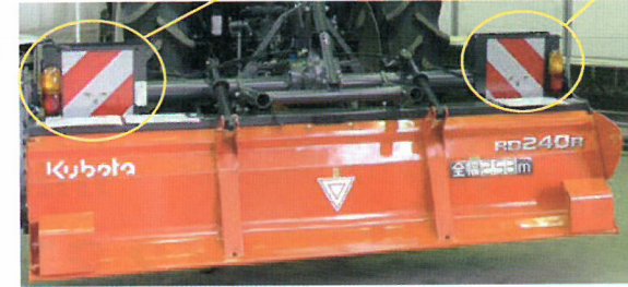
農作業機への反射器（後面：赤）、灯火器（前面：白、後面：赤）及び外側表示板（前後両面）設置例
